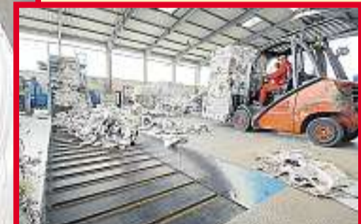
Förderbänder transportieren Unmengen von Altpapier in Pressen.
